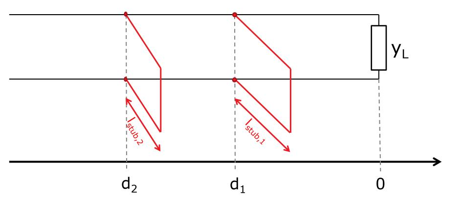
Per adattare il carico posso collocare uno stub in c.c. di **lunghezza**  $I_{stub,1}$  a distanza  $d_1$ , OPPURE uno stub in c.c di **lunghezza**  $I_{stub,2}$  a distanza  $d_2$
