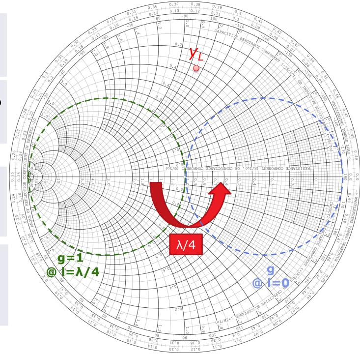
La parte reale dell'ammettenza sul carico è la conduttanza del carico (rossa)
