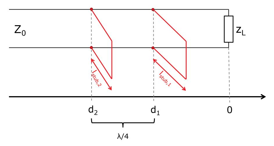
Posiziono il primo stub in corrispondenza della sezione di carico
