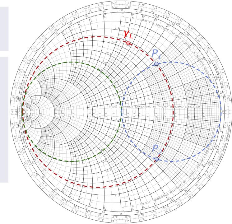
Lo stub 1 deve fornire una suscettanza tale da portare l'impedenza sulla sezione di carico da y<sub>L</sub> a P<sub>1</sub> o P<sub>2</sub>, cioè:
