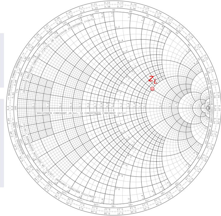
Mi sposto sulla curva a |p| costante in direzione del generatore, ruotando sulla carta di Smith in senso orario, fino a intercettare l'asse delle impedenze reali
