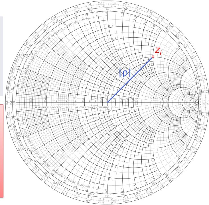
Ruoto sulla curva di ROS fino ad intersecare l'asse delle impedenze Reali.
