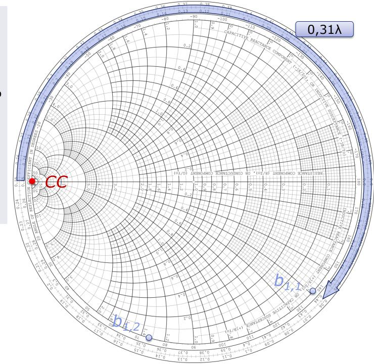
Ottengo l'ammettenza da adattare col  $2^{\circ}$  stub, alla distanza di  $\lambda/4$  dal carico, ruotando sulla carta di  $180^{\circ}$  da  $P_1$  e  $P_2$  in  $P_1$  e  $P_2$
